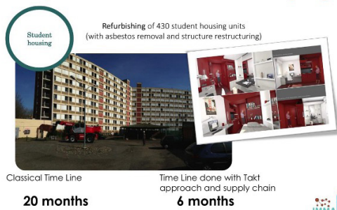
Fig. 5 - Réhabilitation de 430 logements étudiants avec désamiantage : 20 mois en gestion classique, 6 mois avec Takt et supply chain intégrée. (Source : IMMA / Teamoty)
